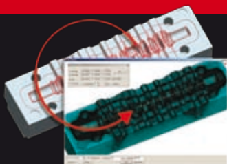
CAD Daten können über direkte Schnittstellen automatisiert übernommen werden.
