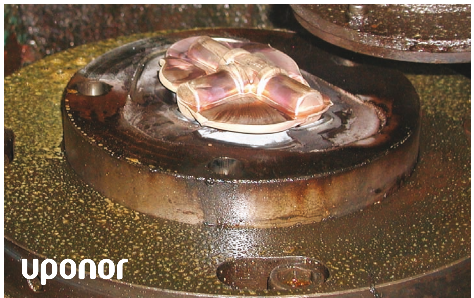
Einzelfertigung eines T-Stückes aus Messing
