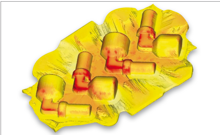
Temperaturverlauf bei der Vierfachschiemiedung eines Messingwinkels
