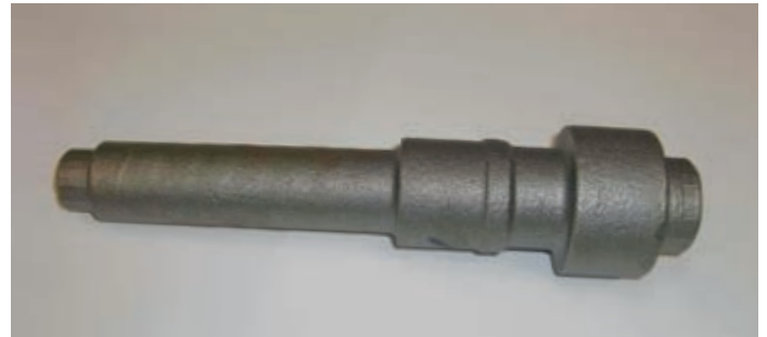
Nach induktiver Erwärmung auf 1240 Grad wird das Bauteil auf einer Querkeilwalze umgeformt
