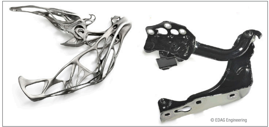
Haubenscharniere im Vergleich: Additive und traditionelle Bauweise
