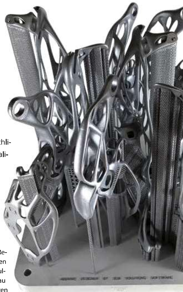
Beim Metall-3D-Druck lassen sich mehrere Komponenten gleichzeitig drucken: Hier zwei Komponenten eines Motorraumscharniers.
