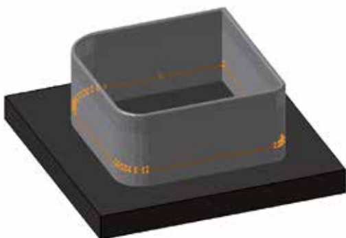
Beispielgeometrie auf der Grundplatte: Das Parasolid wurde direkt aus den im Roboter-G-Code definierten Schweißbahnen erzeugt.
