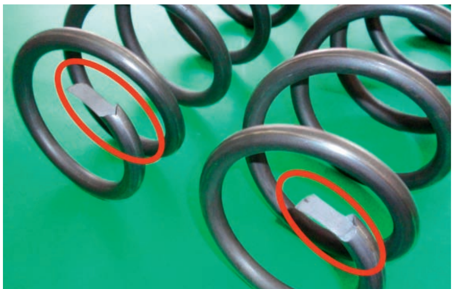
Abbildung 1: Beispiele von beim Umformprozess gebrochener Druckfedern. Bilder: Università degli Studi di Padova
