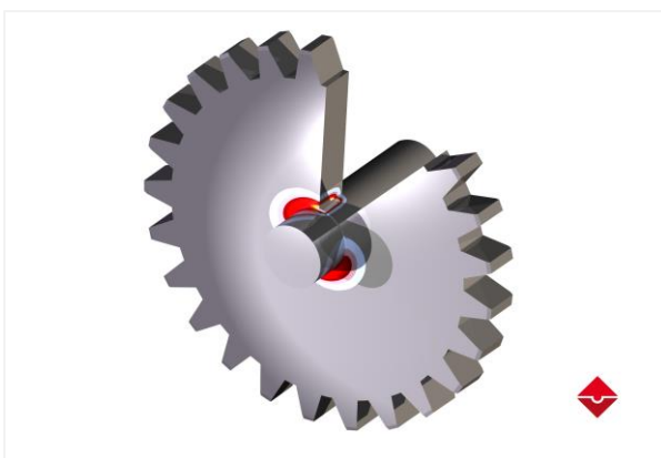
Bild 3: Simulation des Laserschweißens einer Zahnrad-Welle-Verbindung
